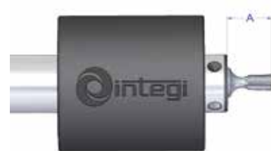
Posición de la brocha. Cota "A" Internal broach position. "A" size
